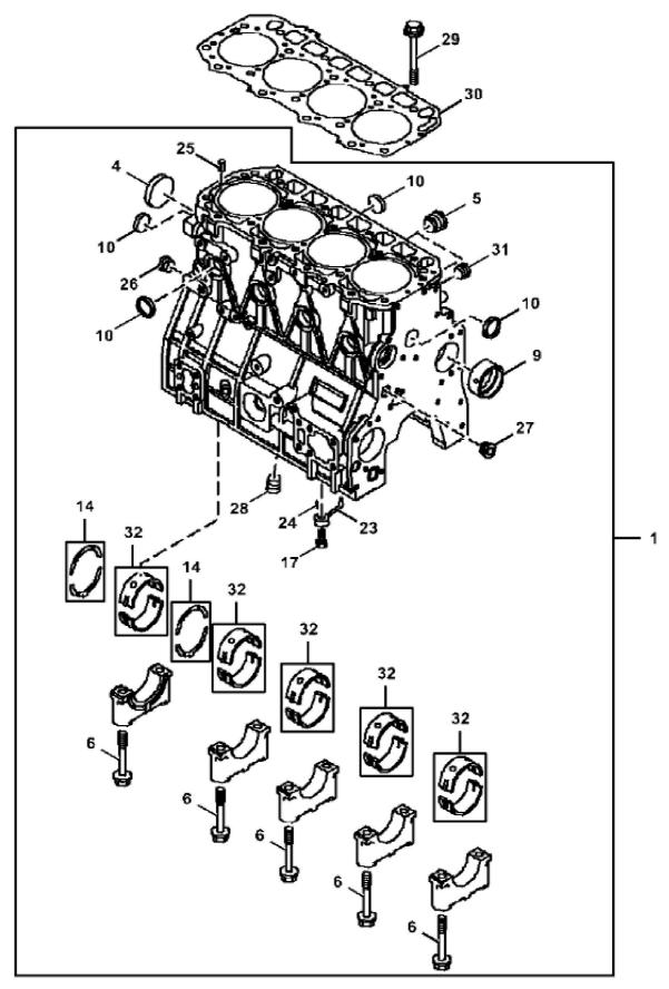
John Deere > Turf And Utility >LOADER, SKID-STEER >324E - LOADER, SKID-STEER >324E Skid Steer Loader (PIN: 1T0324E\_\_\_G297141-) >04 ENGINE, 4TNV98T 4TNV98T-AT408726 >0404 CYLINDER BLOCK 4TNV98T 4TNV98T 4TNV98T >ST763941 - CYLINDER BLOCK
