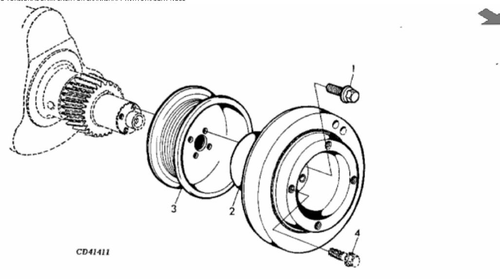
John Deere > Agriculture > TRACTOR > SE6610 - TRACTOR > SE6510, SE6610 Tractors (Europe Edition) > 20 ENGINE, SE6510 (6068DL050), SE6610 (6068TL050) ( - 799999) > ST795926 - CRANKSHAFT PULLEY AND TORSIONAL DAMPENER FOR CRANKSHAFT WITH STRAIGHT NOSE
