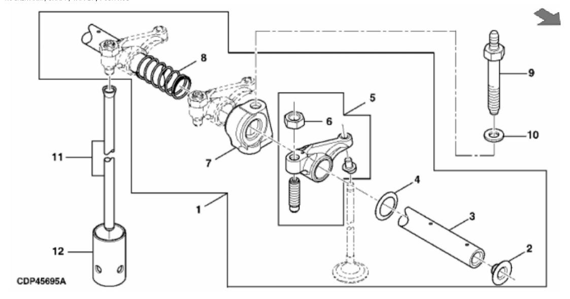
John Deere > Agriculture > TRACTOR > SE6220 - TRACTOR > SE6020, SE6120, SE6220 Tractors (Europe Edition) > 20 ENGINE, SE6 (4045DL070), SE6120 (4045TL070), SE6220 (4045TL071) > ST172407 - ROCKER ARM / SHAFT / TAPPET / PUSH ROD
