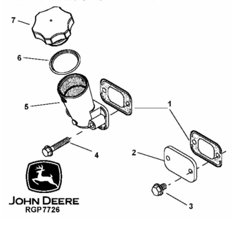
John Deere > Agriculture >TRACTOR >SE6920 - TRACTOR >SE6920 Tractor (Europe Edition) >20 ENGINE 6068TL074-DD21494 - DD21761 >ST449702 - 1203 OIL FILLER NECK
